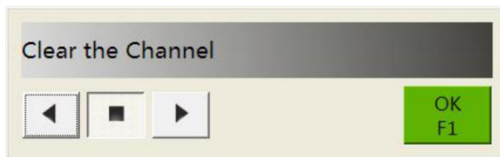
Рис. 4.2 Предупреждение о необходимости очистить досмотровый тоннель
